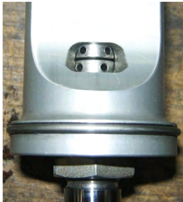
Doppelt einstellbare Einrohrbauweise
