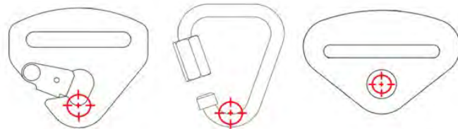
Beispiele von Anlenkpunkten der Gurtbefestigung
